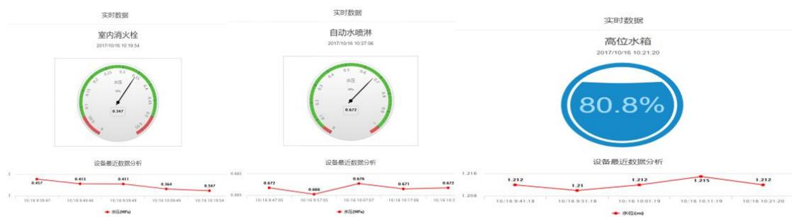
通过物联网技术，实时监测室内消火栓、喷淋末端试水最不利点压力以及消防水箱水池的液位实时情况，水压、液位值实时监测，全实时采集、传递和处理，确保消防用水设施在位、可用。一旦高于或低于预设标准值自动向平台报警。
