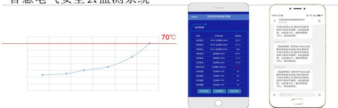
系统通过大数据和云计算等手段实现对电气安全数据多维度、全角度的科学分析及处理，系统对建筑物内的电气线路实时监测的同时，在发现隐患的第一时间可通过手机、电脑等方式发布预警信息，便于我们 24 小时掌握线路运行时存在的用电安全隐患。
